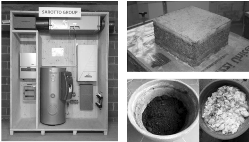
Fig. 1 – A sinistra il prototipo MOTE 2 ; in alto a destra il provino di calcestruzzo a base di lolla di riso; in basso a destra il substrato composto da cellulosa derivante da pannolini monouso riciclati e terriccio.
